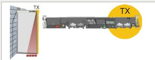
Передатчик (TX) должен быть размещён около края двери который должен быть защищён.
