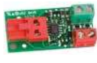
Шинный интерфейс XIB (для платы E045, или E045S, или E024S с фотоэлементом без подключения к шине)
