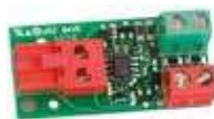
Шинный интерфейс XIB (для платы E045, или E045S с фотоэлементом без подключения к шине)
